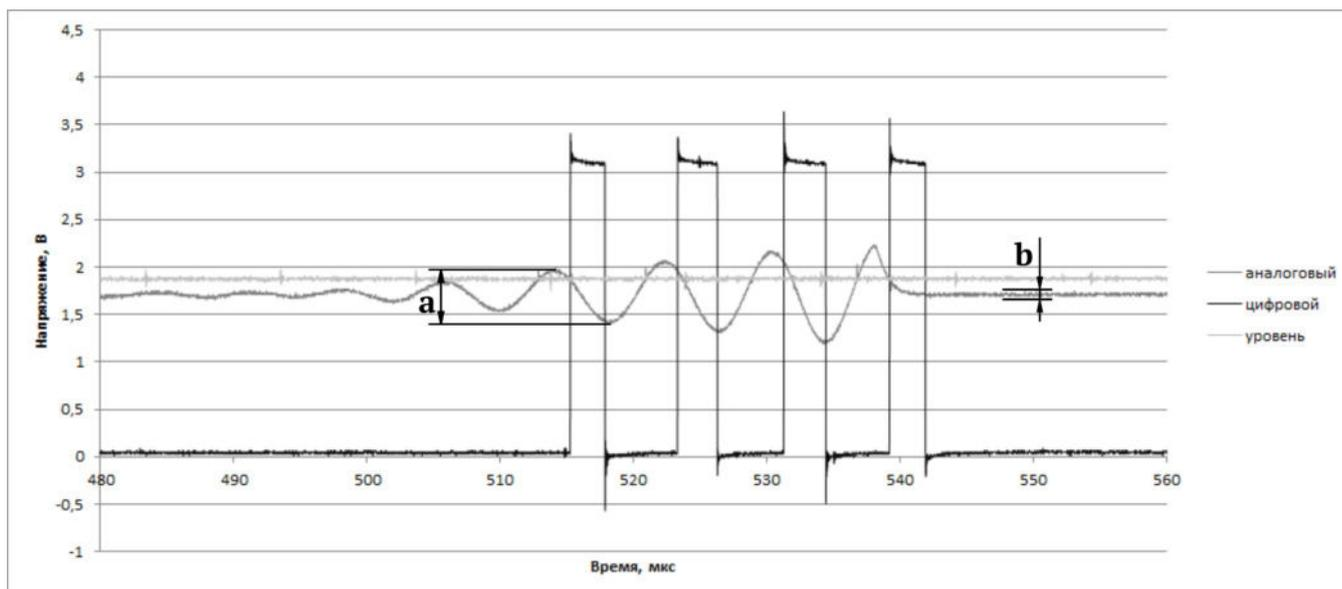
Рисунок 6 — Диагностика отношения «сигнал/шум»
